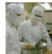
クリーンルーム内でのデバイス試作 Device fabrication in the clean room (Handling of 8-inch silicon wafer)
