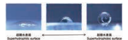
バイオメタリックな発想での表面機能創成(材料表面の濡れ性の制御) An example of surface function: surface wettability control
