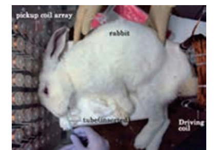
ウサギを用いた生体内の位置情報計測・伝送システムの動物実験 Tracking a nasogastric tube inside a rabbit
