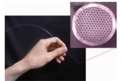
リモート分光イメージング用中空光ファイババンドル Hollow optical fiber bundle for remote Raman spectral imaging
