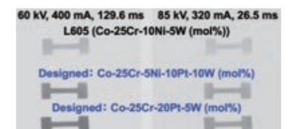
汎用合金(L605)と設計合金のCTイメージング(Ptを含有する設計合金においてX線視認性が向上している) CT images of standard Co-Cr alloy (L605) and designed alloys: X-ray visibility was improved in designed alloys containing Pt.
