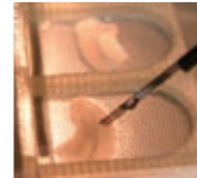
神経プローブによる海馬スライスへの電気刺激と活動電位記録 Electrical stimulation and recording of hippocampal slice with intelligent Si neural probe
