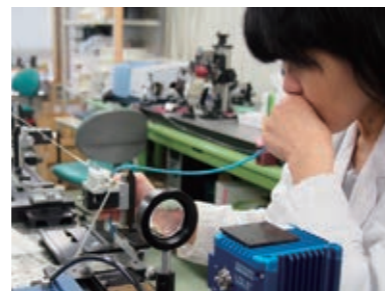
光ファイバガスセルを用いた呼吸分析装置 Breath analysis system using optical-fiber gas cell
