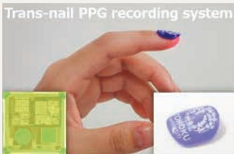
爪に装着し不快感なく PPG・SpO<sub>2</sub>・血圧等を常時計測できる経爪型 PPG 記録システム (専用設計した計測 IC と IC 実装用のつけ爪)
