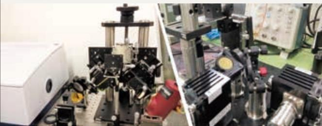
血糖・脂質分析装置：左は初期の大型装置(150×90cm<sup>2</sup>)、右は現在開発中の小型装置(30×30cm<sup>2</sup>)
