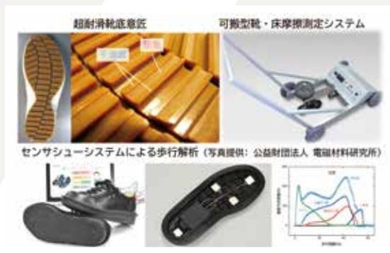
転倒予防のための研究開発・実用化の例(耐滑鞋底意匠、摩擦試験システムは実用化されています)
