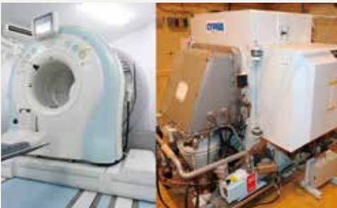
サイクロトロン・ラジオアイソトープセンターに設置されているPET装置(左)と小型加速器装置(右)
