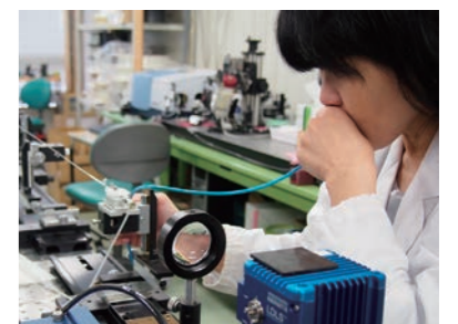
光ファイバガスセルを用いた呼気分析装置 Breath analysis system using optical-fiber gas cell
