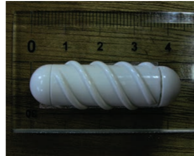
カプセル内視鏡駆動用アクチュエータ Actuator for Capsule Endoscope
