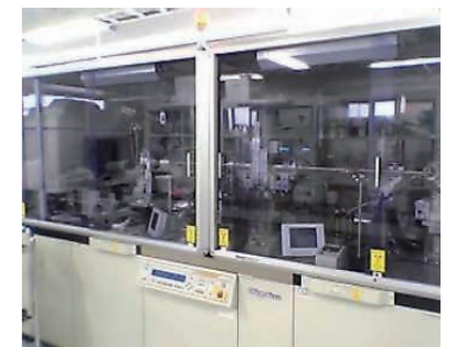
X線回折装置による反射データの測定 Measurement of reflection data by x-ray diffractometer
