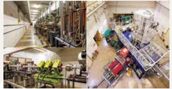
先端量子ビーム科学研究センター (RARIS) が所有するサイクロトロン (左) と電子直線加速器 (右)
