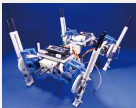
さまざまな四脚動物種の足並みを再現可能な生物規範型制御を実装した四脚ロボット
