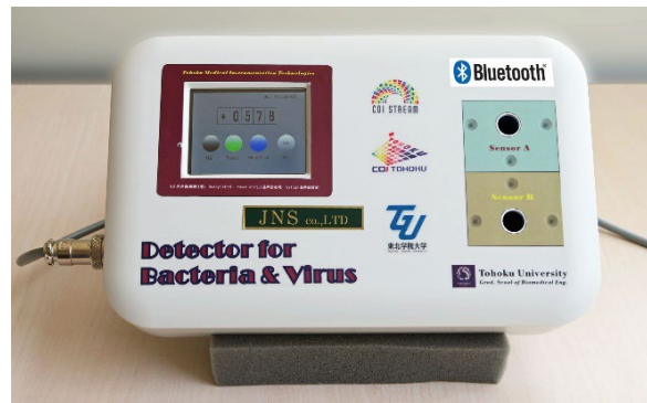
開発したポータブル微生物センサ
